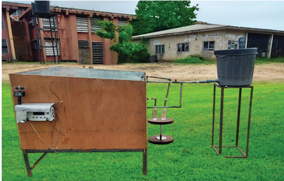
Figure 2: Actual fabricated solar still.
